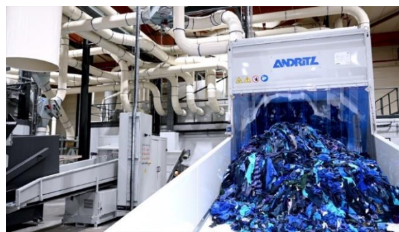
Sortierte und zerkleinerte Textilabfälle zur Weiterverarbeitung in Zerreißmaschine © SBO EVENT
